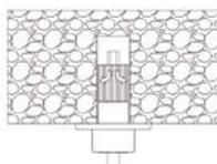
天井内作業不要。天井に穴をあけ、本体を差し込んでドライバーで締め付けるだけでOK!!
