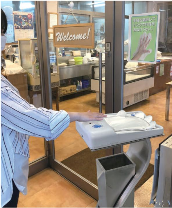
あらゆる職場で使い捨て手袋を着用するためのより無菌の方法を提供します。ディスペンサーのセンサーによりエアで付属の手袋を膨らませるので、手をスライドさせるだけで手袋を装着出来ます。プロセス全体がタッチフリーです。このシステムは汚染を最小限に抑え、スタッフと顧客にとってより安全です。滅菌手袋は、ウイルスやバクテリアの粒子を寄せ付けないようにするのに役立ちます。ニトリルまたはラテックス製の手袋を使用している場合、従業員は手袋を着用しているときに手袋に触れる必要があり、これは汚染を引き起こします。タッチレスエアログローブディスペンサーを使用すると汚染を減らすことを可能にし、より衛生的な状態になります。
